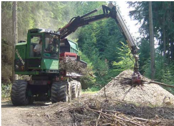
Figura 36: astilladora móvil tratando residuos forestales Fuente: Ecosistemas
