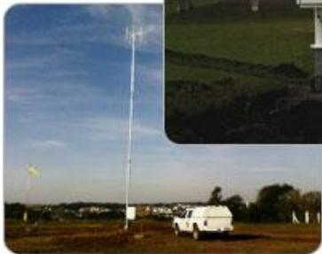
*Estação de Detecção de Descarga Atmosférica*
