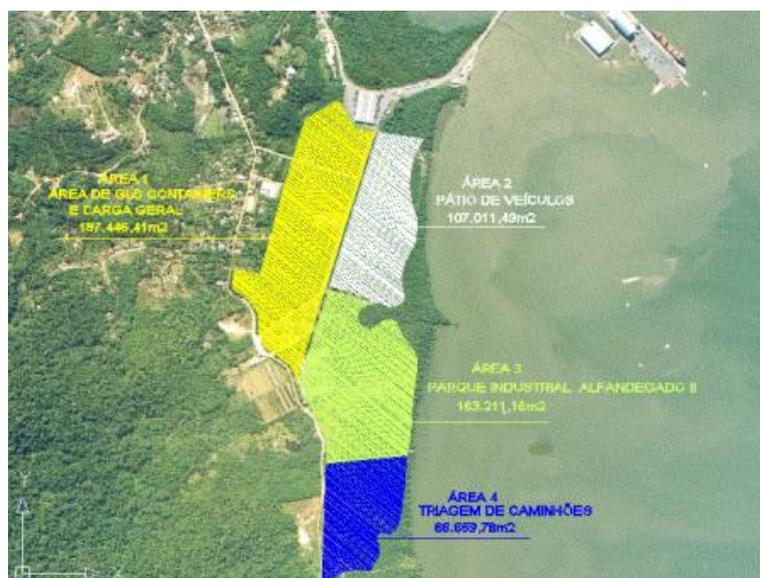
**Figura 47.** Zoneamento proposto pelo PDZPO 2006 para áreas próximas ao Terminal da Ponta do Félix.
