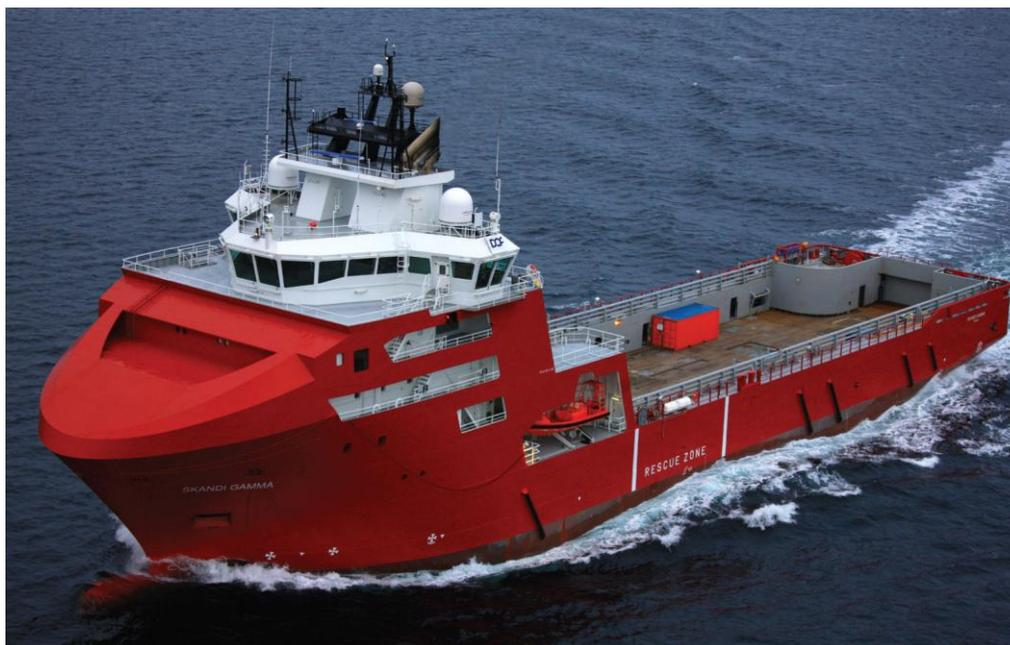
**Figura 69.** PSV Skandi Gamma – 94,9 m compr. x 20 m boca x 5,9 m calado
