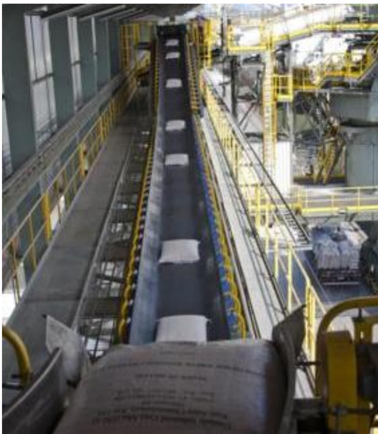
**Figura 89.** Esteira que leva a carga do armazém até o shiploader de carga ensacada
