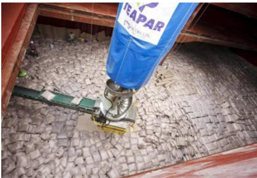
**Figura 90.** Carregamento do navio através do shiploader para carga ensacada
