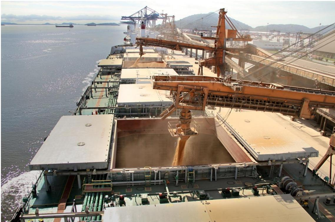
**Figura 75.** *Shiploaders* abastecendo simultaneamente o navio
