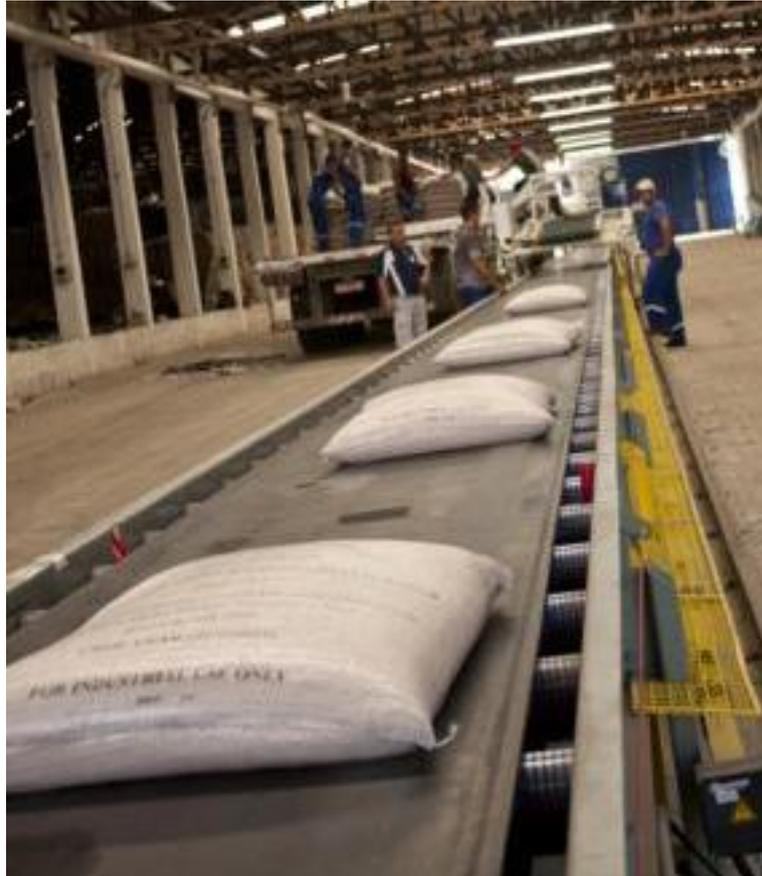
**Figura 88.** Colocação da carga ensacada na esteira, dentro do armazém
