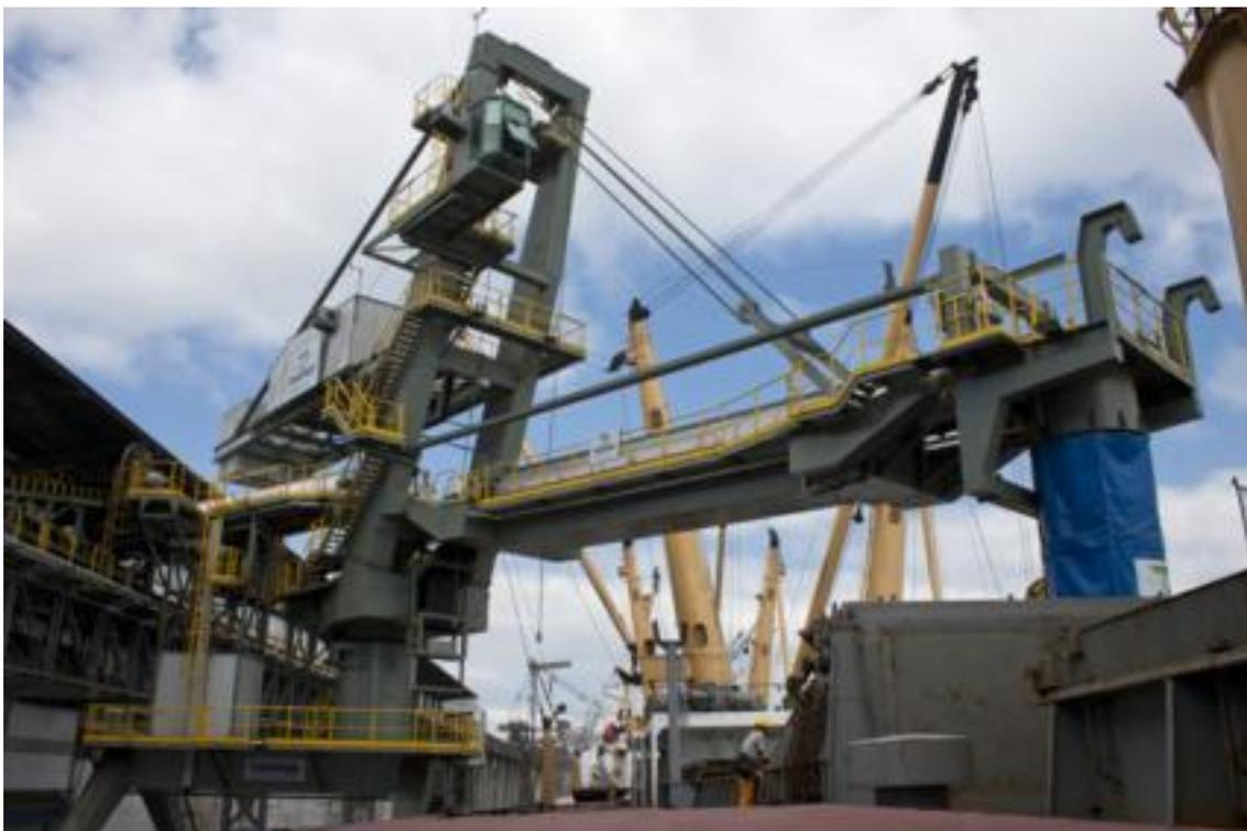
**Figura 87.** Fotografia do shiploaders de carga ensacada do Berço 205
