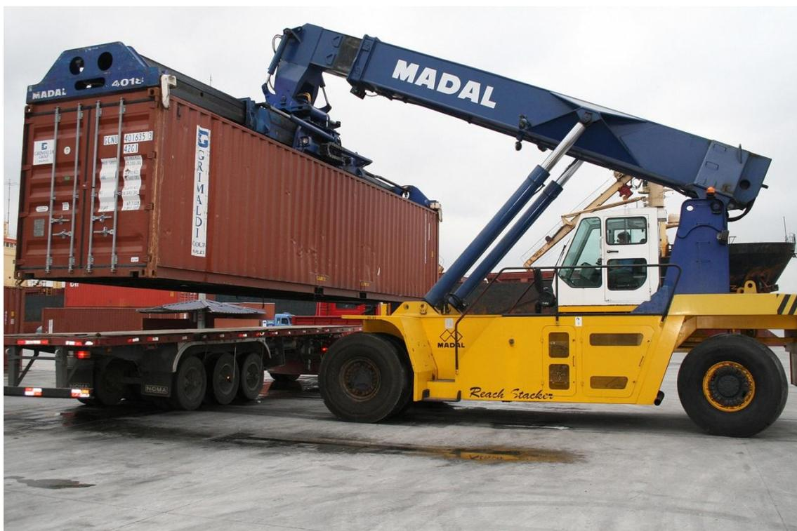
**Figura 99.** Carregamento de contêiner em caminhão com *reach steacker*
