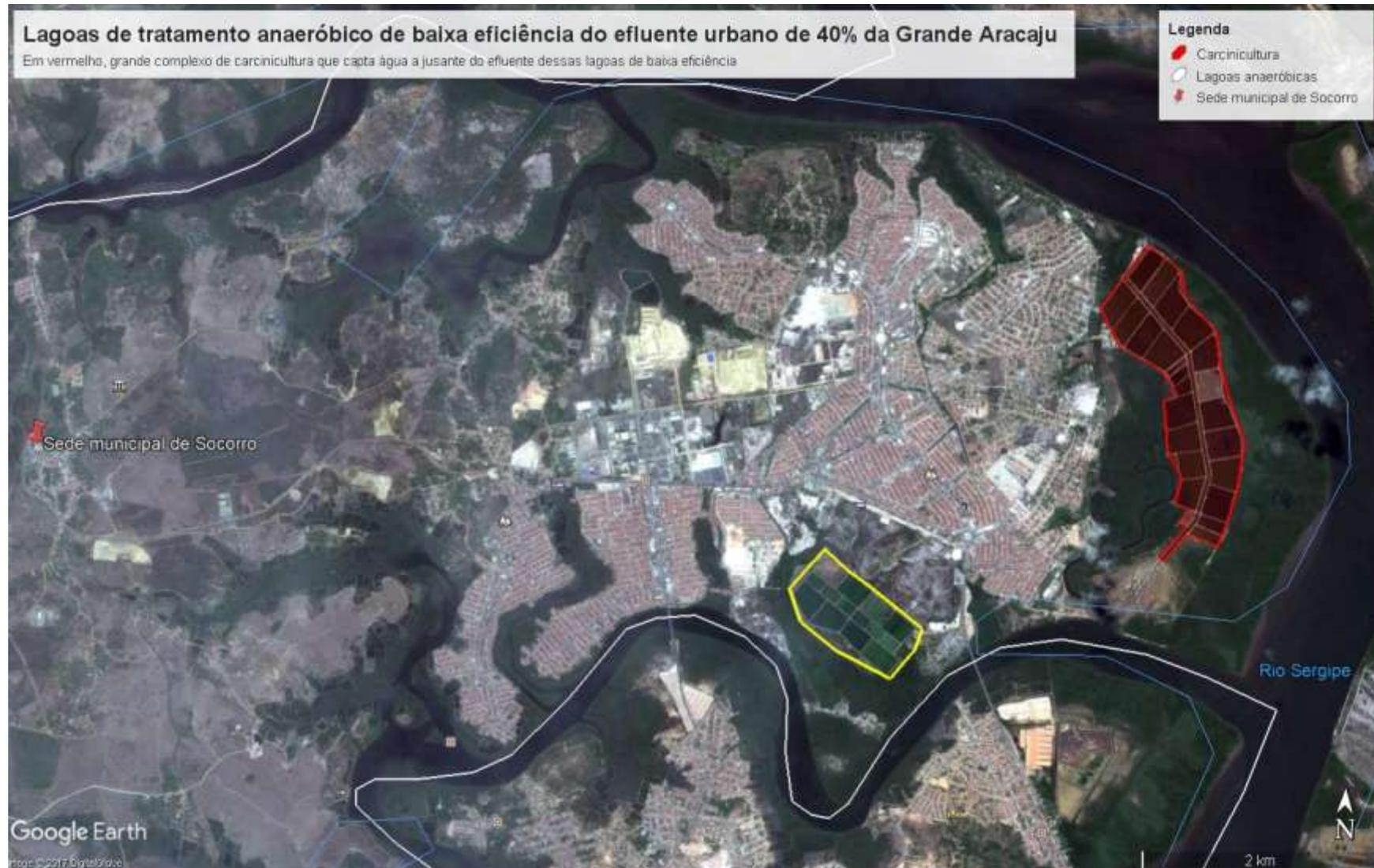
**Figura 5: Imagem de satélite capturada em 2017. Município de Socorro, Grande Aracaju. Em amarelo destaca-se as lagoas de tratamento anaeróbico de baixa eficiência dos efluentes urbanos de 40% da Grande Aracaju. Em vermelho, tanques de carcinicultura com captação de água do Rio do Sal à jusante do efluente dessas lagoas.**
