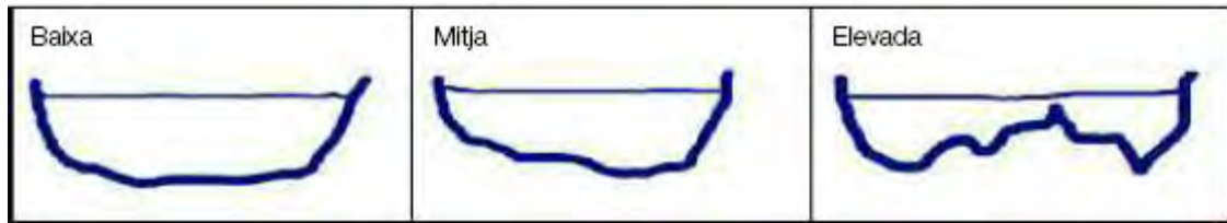
Figura 10. Categories segons la variació de la fondària del canal fluvial (Pedersen i altres , 2004).
